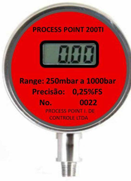
Indicado para uso em laboratório como padrão e para monitoração em campo com alta precisão, o manômetro PP-200I foi desenvolvido com a mais moderna técnica de condicionamento de sinais utilizando sensores piezoresistivos, o instrumento permite a amostragem de grandezas de pressão com alta resolução em um display de cristal líquido de 3½ dígitos.
